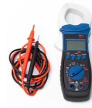
Multímetro de pinza con pantalla LCD, bolsillo de nylon, baterías y juego de cables de prueba.
