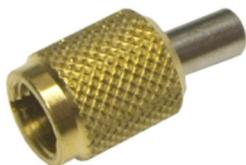
Sensibilidad (fuga de referencia) para detectores electrónicos de gas. Para refrigerante propano R-90/R-290; caudal de 5 gramos por año. Conexión de tuerca de ensanchamiento para facilitar su uso con equipos de refrigeración estándar.
